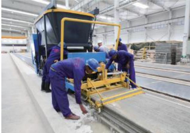
图：预应力空心楼板生产线
